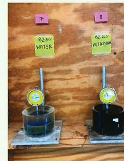
Essais de gonflement sur sol traité et non traité par RemediaClay.
