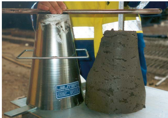
La qualité et la conformité du coulis fraîchement prélevé sont continuellement contrôlés en mesurant l'affaissement.
